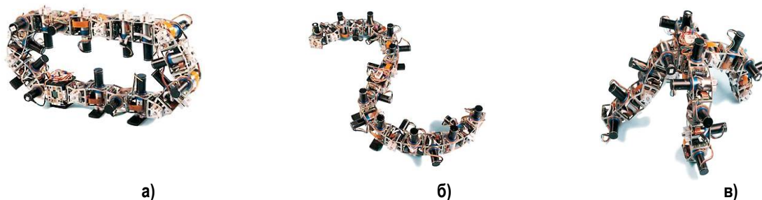
Рис. 1. Некоторые возможные конфигурации многозвенных роботов с адаптивной кинематической структурой PolyBot (PARK, Xerox, USA): а) конфигурация типа «колесо», б) конфигурация типа «змея», в) конфигурация типа «паук».
