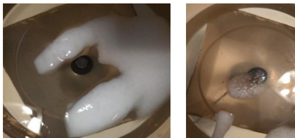
Рисунок 6. Результат воздействия ультразвука на ледовую
