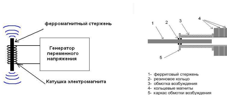
Рисунок 1. Схема генератора и магнитострикционного вибратора
