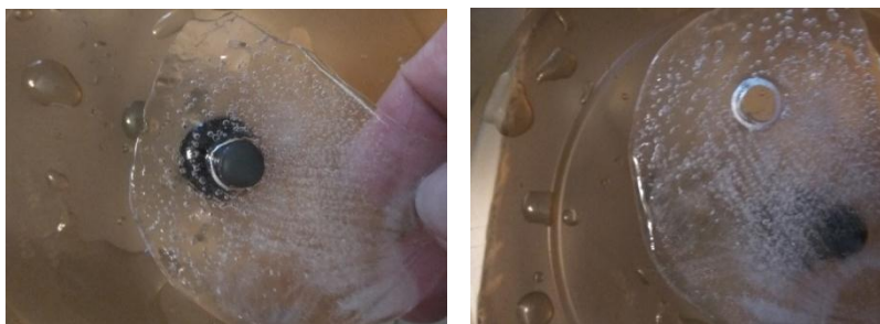
Рисунок 5. Воздействие ультразвука непосредственно на ледовую поверхность
