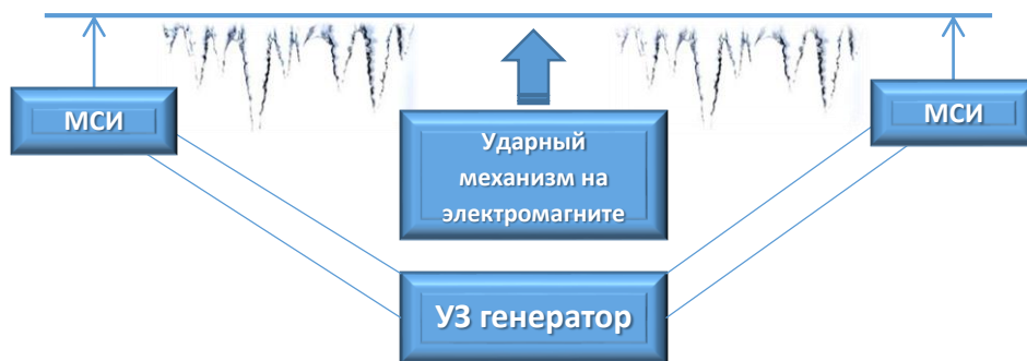
Рисунок 7. Схема ультразвукового устройства с ударным механизмом
