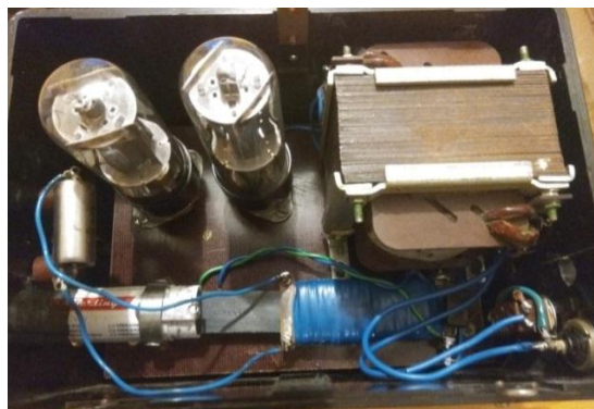
Рисунок 2. Электрическая схема лампового ультразвукового генератора и готовая модель
